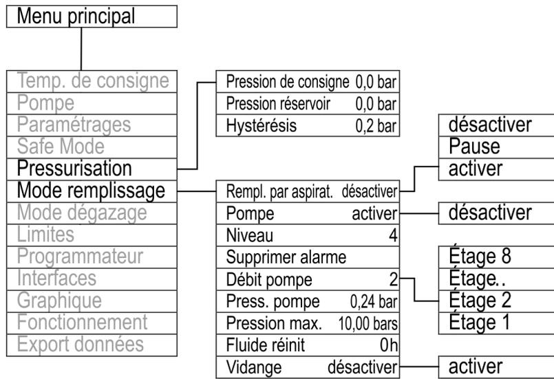
Fig. 36: Structure de menus de la pressurisation
