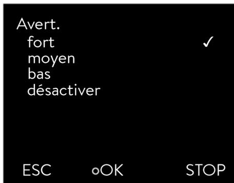
Fig. 47: Régler l'intensité sonore
