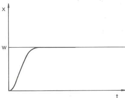
Fig. 74: Réglage optimal
