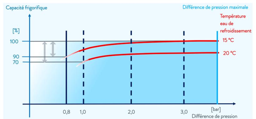
Fig. 95: Différence de pression d'eau de refroidissement
